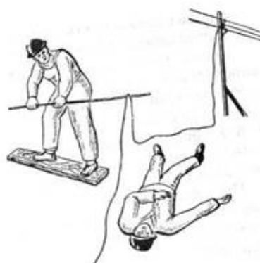
Рис. 2. Средства личной защиты при освобождении от действия электрического тока в электроустановках напряжением до 1000 В
