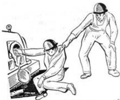
Рис. 3. Освобождение пострадавшего от действия электрического тока, находящейся под напряжением до 1000 В
