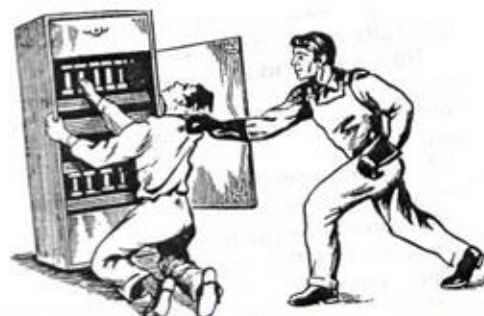
Рис. 4. Освобождение пострадавшего от токоведущей электрической части
